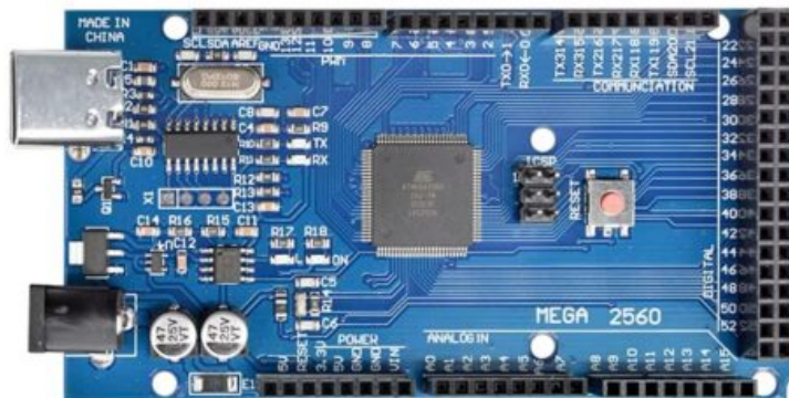
Vue réelle : USB-C, CH340G, ATmega2560, jack CC et connecteurs du format Mega
